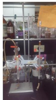
5 gr de extracto  $\text{CH}_2\text{Cl}_2$ :MeOH se sometieron a un proceso de purificación mediante cromatografía en columna (150 gr de silica gel), el sistema de elusión fue *n*-heptano:acetona (98:02 → 70:30).
